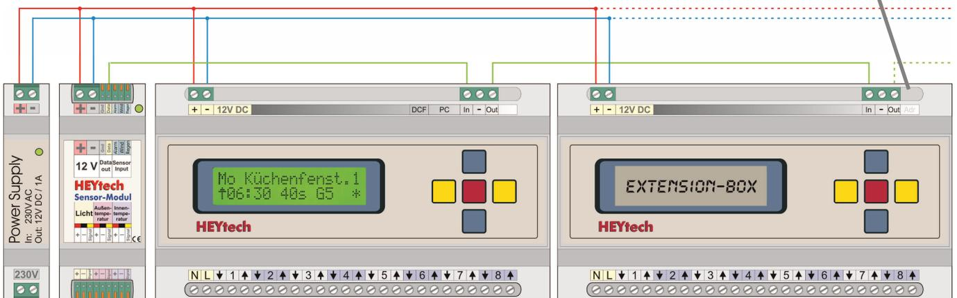
Abbildung 4: Anschluss Extension-Box
