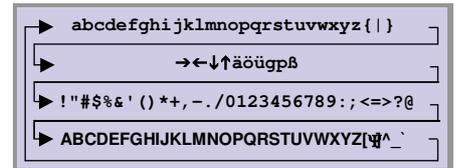
Die Leertaste befindet sich zwischen dem "ß" und dem "!". Buchstaben mit Unterlängen (g, p) sowie Umlaute (ä, ö, ü) sind ebenfalls verfügbar: Sie erscheinen vor der Leertaste.
