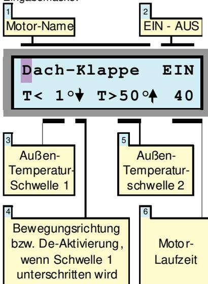
Die wesentliche Aufgabe der Außen-Temperatursteuerung ist es, bei Unterschreitung einer bestimmten Außentemperatur dafür zu sorgen, dass Stellmotoren in eine
