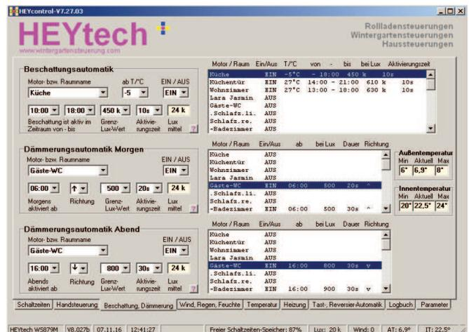
**Maske Beschattung, Dämmerung:** Einrichtung der Beschattungautomatik sowie der Dämmerungsautomatik für Morgen und Abend
