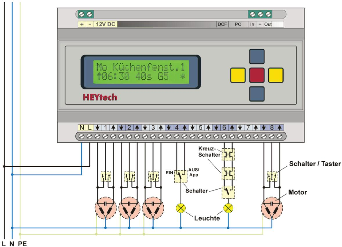
Abbildung 2a: Gemischter Anschluss von Motoren und Leuchten
