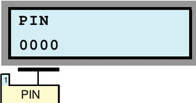
Die Eingabe einer PIN soll den nicht legitimierten Zugriff auf die Steuerung von außen verhindern. Die Eingaben an der Tastatur der Steuerung sind von der PIN nicht betroffen.
