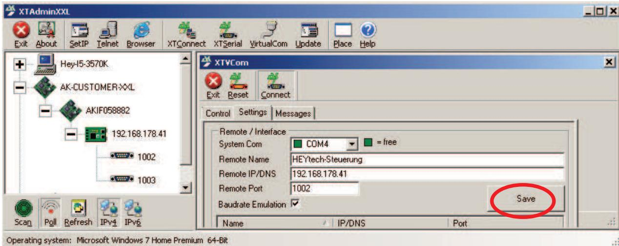
Jetzt können Sie auf jedem PC innerhalb des Heimnetzes die Windows-Bediensoftware HEYcontrol starten und haben (in diesem Beispiel) unter dem Port COM4 Zugriff auf die Steuerung.
