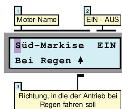
Wenn an Ihre HEYtech-Steuerung ein Regen-Sensor angeschlossen ist, so besteht die Möglichkeit, regenempfindliche Sonnenschutz-einrichtungen automatisiert einfahren zu lassen.
