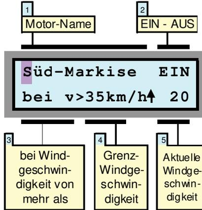
Wenn an Ihrer HEYtech-Steuerung ein Wind-Sensor angeschlossen ist, können Sie bei entsprechender Programmierung dafür sorgen, dass windempfindliche Sonnenschutz-einrichtungen bei zu starkem Wind eingefahren werden. Die Richtung, in die der jeweilige Antrieb bei starkem Wind (und bei Regen) laufen soll, legen Sie in der Eingabemaske "Einfahren bei Regen" fest.
