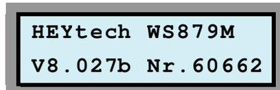
Nach Zuschaltung der Netzspannung wird im Display des Gerätes für kurze Zeit der Gerätetyp (WS879M) sowie die Versions-
