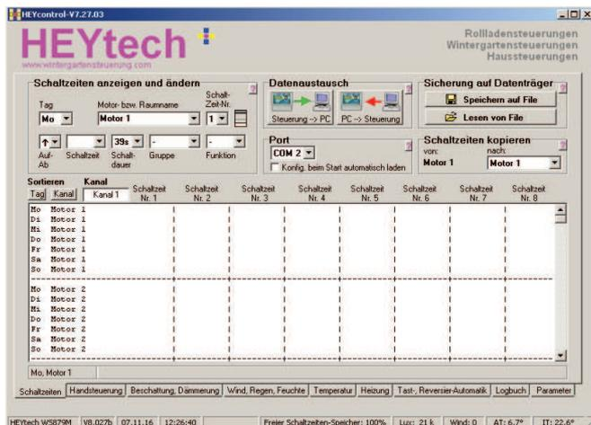
**Maske Schaltzeiten:** Auswahl des COM-Ports, Datenaustausch zwischen Steuerung und PC, Benennung der Kanäle, Einrichtung fester Schaltzeiten, Speichern und Einlesen von Konfigurationen
