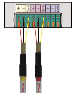
Abbildung 7: Licht- und Temperatursensor
