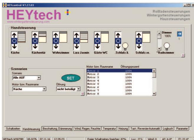
**Maske Handsteuerung:** Handsteuerung von Rollläden, Jalousien, Leuchten, Dimmern usw. Einrichtung und Aktivierung von Szenarien
