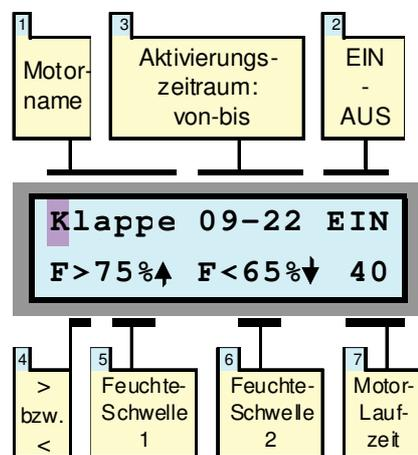
Die Aufgabe der Luftfeuchtigkeits-Steuerung ist es, die relative Luftfeuchtigkeit im Wintergarten innerhalb eines vorgegebenen Bereiches zu halten. Bei zu hoher Luftfeuchtigkeit besteht die Gefahr einer Botrytisinfektion (Schimmelpilze). Andererseits gibt es auch Pflanzen, die gegen eine zu geringe Luftfeuchtigkeit empfindlich sind. In diesem Fall kann bei Unterschreitung einer Mindestfeuchtigkeit befeuchtet werden, zum Beispiel durch Sprühdüsen.
