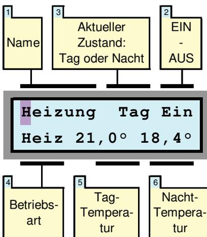
Die Heizungs-Steuerung übernimmt die Funktion eines äußerst präzisen Raum-
