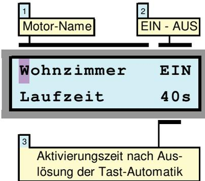
Die Steuerung WS879 ist mit einer Tast-Automatik ausgestattet. Hierdurch erhöht sich der Bedienungskomfort beim Schalten der Antriebe über raumseitig installierte Bedien-Taster.
