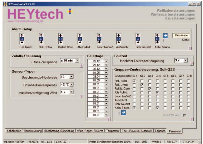
**Parameter:** In dieser Maske kann eine Vielzahl von Parametern eingegeben werden. Weiterhin werden hier das Alarm-Setup und die Zuordnung der Gruppenzentraltaster festgelegt.
