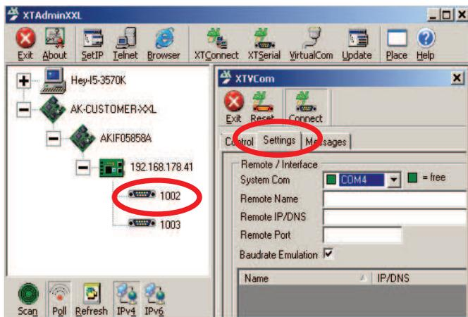
Durch einen Klick auf den im linken Teil mit 1002 gekennzeichneten Port\* werden rechts die zugehörige Remote IP und ein Remote Port eingetragen. Den "Remote Name" können Sie frei selbst wählen. Die "Remote IP" belassen Sie so, wie sie eingetragen wurde und den "Remote-Port" ändern Sie zu 1002, 3000, 6500, 9100 oder 10001.
