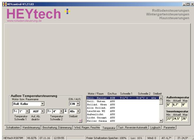
**Maske Temperatursteuerung:** Im Bereich der Rolllädensteuerungen steht eine Außentemperatursteuerung zur Verfügung. Hier können temperaturabhängige Schaltvorgänge definiert werden.
