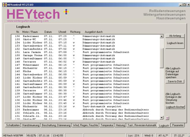
**Logbuch:** Jeder Schaltvorgang wird in der Steuerung in einem Logbuch protokolliert. Hier können Sie das Logbuch abrufen, auf Platte speichern und löschen.
