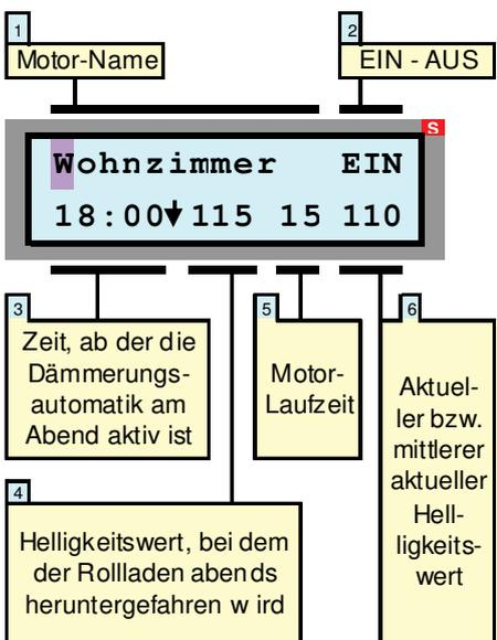
Die Dämmerungsautomatik bewirkt, dass sich z.B. ein Rollladen am Morgen bei einer bestimmten Helligkeit automatisch öffnet bzw. am Abend mit Eintritt der Dämmerung automatisch schließt.
