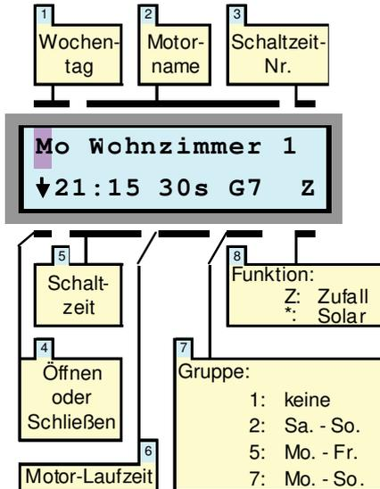
Dieses Auswahlmenü werden Sie immer dann benutzen, wenn Sie feste Schaltzeiten programmieren wollen. Soll z.B. der Rollladen im Wohnzimmer jeden Tag um 21:15 Uhr schließen, so werden Sie dies durch Aktivierung dieses Auswahlmenüs programmieren.
