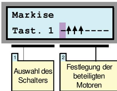
Die Kanäle 1 bis 8 können als Eingänge für Zentraltaster verwendet werden. Als Bedienelemente werden handelsübliche Jalousietaster verwendet.
