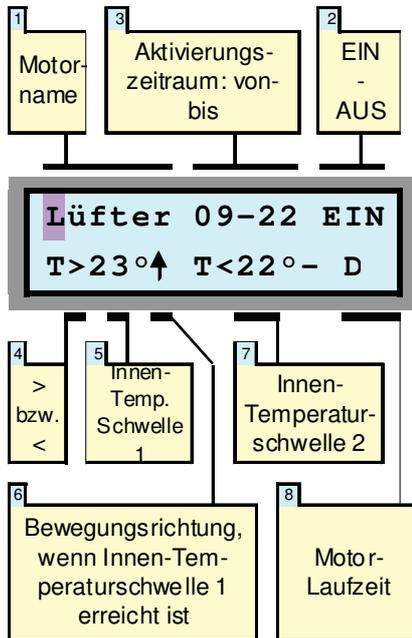
Mit der Innen-Temperatursteuerung werden vorzugsweise Ventilatoren, Lüfter sowie Heiz- und Klimageräte angesteuert. Aber auch Lüftungsklappen oder Fenster können in Abhängigkeit der Innentemperatur des Wintergartens geöffnet und geschlossen werden (obwohl letzteres mit der im folgenden Kapitel beschriebenen "Proportionalen Innentemperatursteuerung" noch komfortabler möglich ist).
