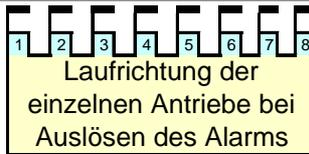
Über einen am Alarm-Eingang angeschlossenen Schalter oder Taster können alle Motoren zeitgleich angesteuert werden. Hierbei sind die Betriebsweisen "Zentral-Taster" und/oder "Alarm-Schalter" möglich.
