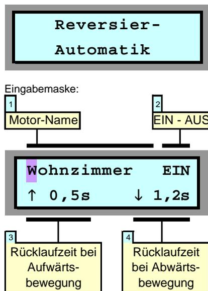
Bei den meisten Jalousien (Horizontal-Lamellen-Jalousien, Raff-Stores, Vertikal-Lamellen-Jalousien usw.) bewirkt eine Veränderung der Stellposition zunächst ein vollständiges Schließen der Lamellen. Soll dann ein bestimmter Öffnungswinkel der Lamellen wieder eingestellt werden, so muss der Antrieb für eine definierte Zeit in die entgegengesetzte Richtung bewegt werden.
