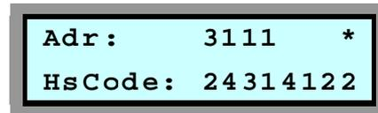
Bei installiertem Funk-Empfangsmodul (Option) dient die Anzeigemaske zusätzlich als Monitor für eingehende Funktelegramme von FS20-kompatiblen Handsendern, wobei in der oberen Zeile die Adresse und darunter
