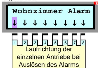
Über einen am Alarm-Eingang angeschlossenen Schalter oder Taster können alle Motoren zeitgleich angesteuert werden. Hierbei sind die Betriebsweisen "Zentral-Taster" und/oder "Alarm-Schalter" möglich.
