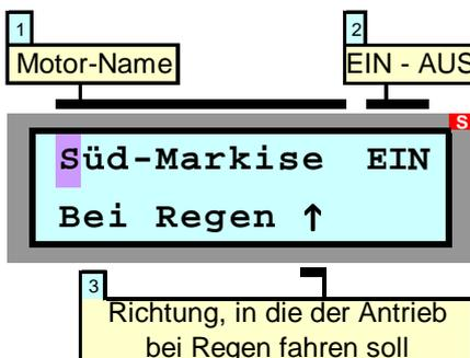
Wenn an Ihre HEYtech-Steuerung ein Regen-Sensor angeschlossen ist, so besteht die Möglichkeit, regenempfindliche Sonnenschutz-einrichtungen automatisiert einfahren zu lassen.
