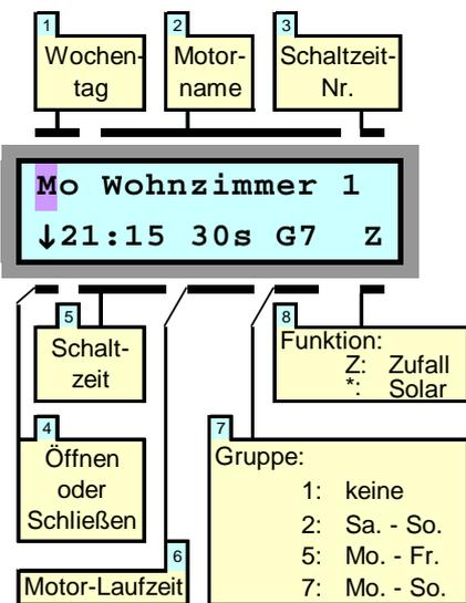
Dieses Auswahlmü werden Sie immer dann benutzen, wenn Sie feste Schaltzeiten programmieren wollen. Soll z.B. der Rollladen im Wohnzimmer jeden Tag um 21:15 Uhr schließen, so werden Sie dies durch Aktivierung dieses Auswahlmüs programmieren.
