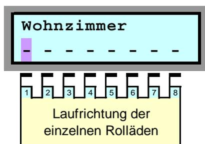
Jeder an die Steuerung angeschlossene Motor kann von der Zentralsteuerung manuell geschaltet werden.
