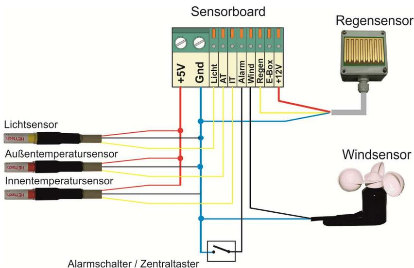
Abbildung 9: Anschluss der Sensoren
