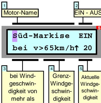
Wenn an Ihrer HEYtech-Steuerung ein Windsensor angeschlossen ist, können Sie bei entsprechender Programmierung dafür sorgen, dass windempfindliche Sonnenschutz-einrichtungen bei zu starkem Wind eingefahren werden. Die Richtung, in die der jeweilige Antrieb bei starkem Wind (und bei Regen) laufen soll, legen Sie in der Eingabemaske "Einfahren bei Regen" fest. Sie sollten bei der Wind-Steuerung immer beachten, dass auch bei exakter Program-
