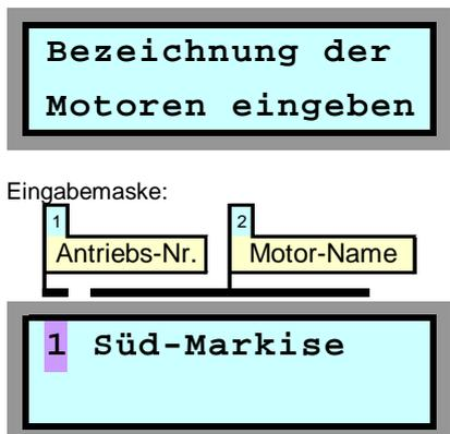
In der Eingabemaske "Bezeichnung der Motoren eingeben" werden die Namen für die Antriebsmotoren festgelegt. Dies sollte immer einer der ersten Schritte nach der Inbetriebnahme des Gerätes sein, da Sie dann bei der weiteren Programmierung der Steuerung die einzelnen Motoren immer unter dem zugeordneten Namen ansprechen können. Dies ist wesentlich angenehmer als sich immer merken zu müssen, welches denn der "Motor 1" eigentlich ist.
