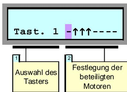
Mit den Zentraltastern (vgl. Abbildung 5) lassen sich z.B. alle Rollläden im Wohnzimmer, des Erdgeschosses, alle nach Süden ausgerichteten Rollläden oder auch insgesamt alle Rollläden von einer zentralen Stelle aus öffnen oder schließen.
