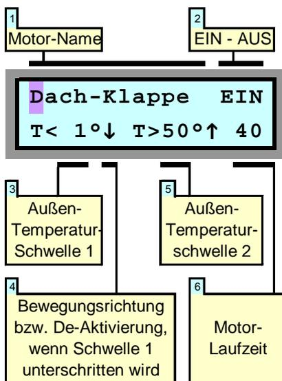
Voraussetzung für die Verwendung der Außen-Temperatursteuerung ist, dass ein Temperatursensor an das Sensorboard der Steuerung angeschlossen ist.
