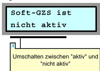
Ihre Steuerung ist mit einer Soft-Gruppen-Zentralsteuerung ausgestattet. Dies bedeutet, dass die Kanäle 1 bis 8 als Eingänge für Zentraltaster verwendet werden können. Als Bedienelemente werden handelsübliche Jalousietaster verwendet.
