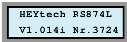
Nach Zuschaltung der Netzspannung wird im Display des Gerätes für kurze Zeit der Gerätetyp (z.B. RS874L) sowie die Versionsnummer der
