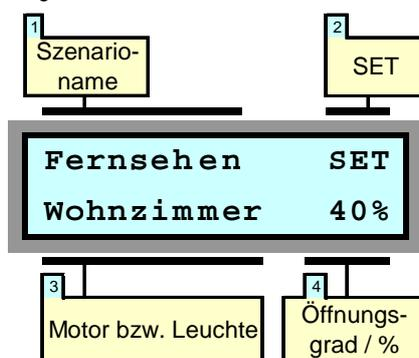
Es können bis zu 5 Szenarien in der Steuerung definiert werden. Szenarien zeichnen sich dadurch aus, dass innerhalb eines Szenarios für jeden Motor ein Öffnungszustand und für jede Leuchte ein Schaltzustand definiert werden kann.
